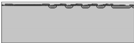
图3 600 V 终端仿真模型
